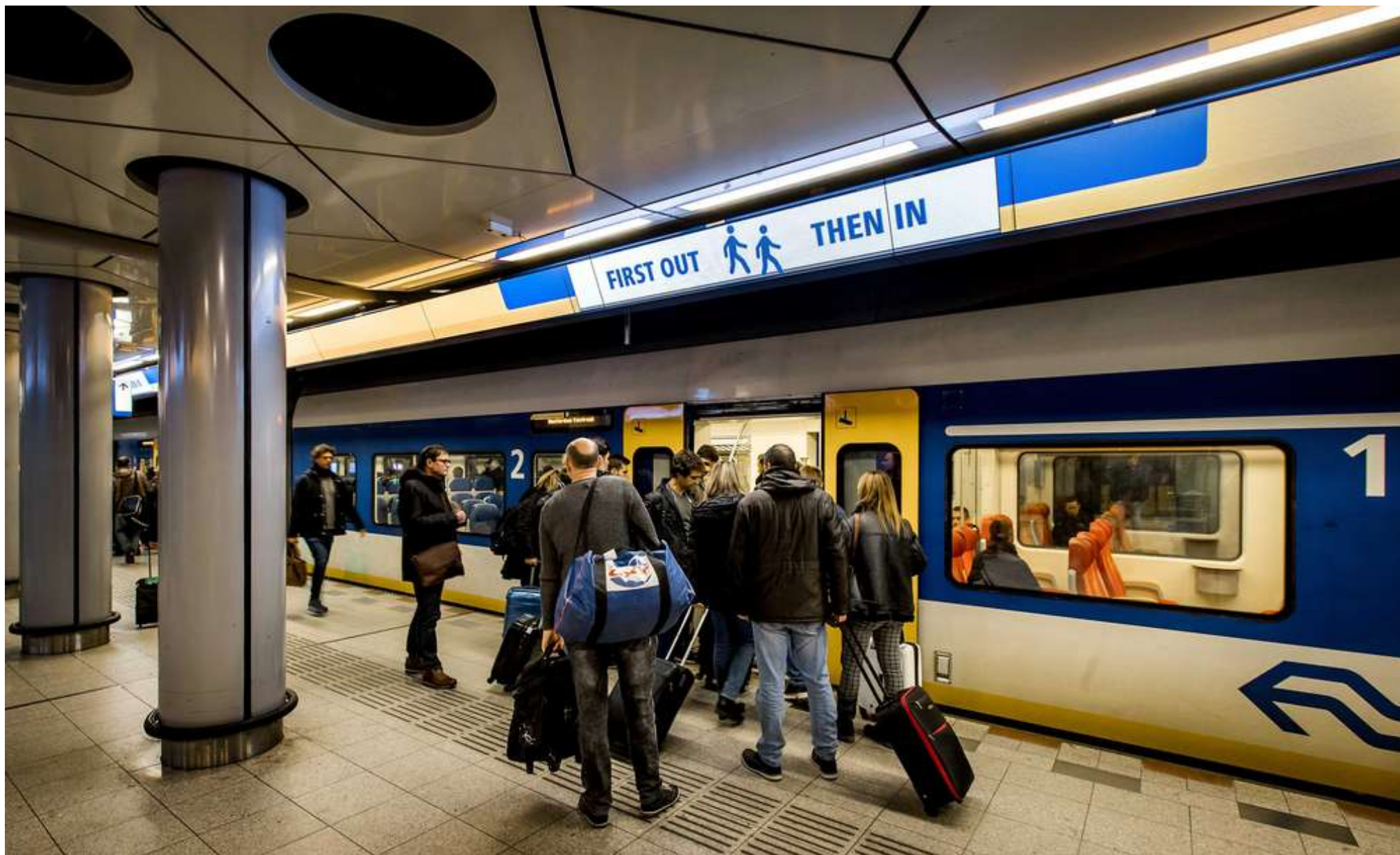
FOTO ANP - Station Schiphol heeft een led-balk gekregen die treinreizigers moet helpen om sneller in te stappen. Op de balk boven het perron wordt nog voor aankomst van de trein aangegeven waar de deuren in de rijtuigen zich bevinden als de trein eenmaal is gestopt.
